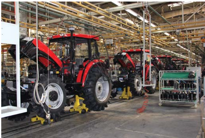
Рис. 2 – Конвейєр для збирання тракторів УТО на державному тракторному заводі компанії “УТО Group Corporation” (Китай, м. Лоян)
