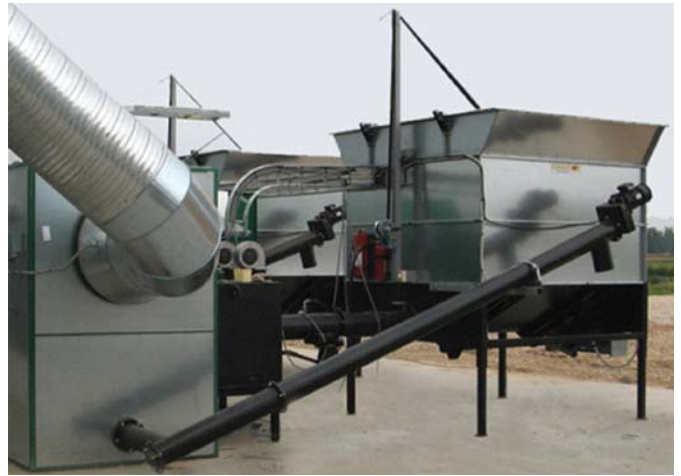
Рис. 2 – Твердотопливний теплогенератор «МЕРУ» зі стокером
