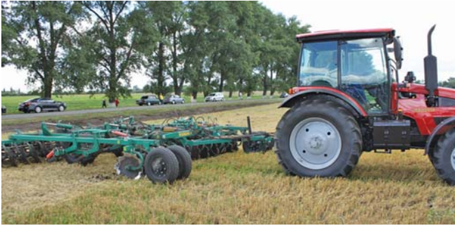
Рис. 2 – Загальний вигляд агрегата на базі трактора МТЗ 1523 «Беларус» (РУП МТЗ) та диско-чизеля ДИЧЕР-5,2 (ТОВ НВП «БІЛОЦЕРКІВМАЗ»)
