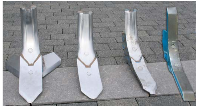
Рис. 2 – Набір швидкознімних лап культиватора КАРАТ
