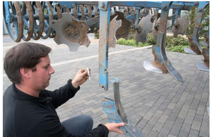
Рис. 3 – Встановлення змінних лап на культиватор КАРАТ
