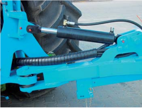
Рис. 4 – Система навішування культиватора KARAT на трактор
