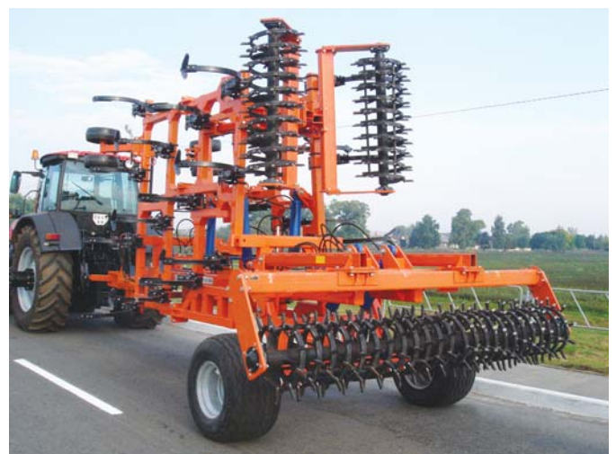
Агрегат универсальный комбинированный почвообрабатывающий АДУ-6 АКЧ с упругой трехстадийной защитой чизельных рабочих органов
