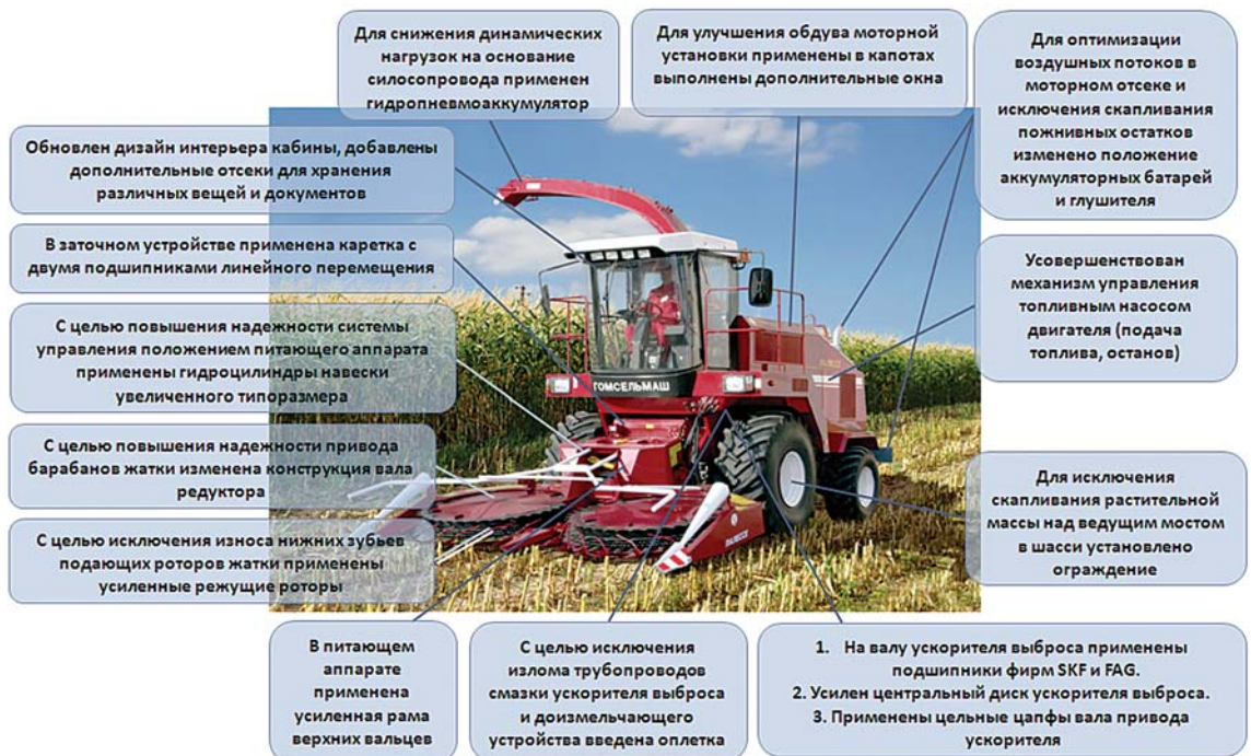
Рис. 6 – Конструкционные изменения, внесенные в комплекс кормоуборочный высокопроизводительный КВК-800 "ПАЛЕССЕ FS80"
