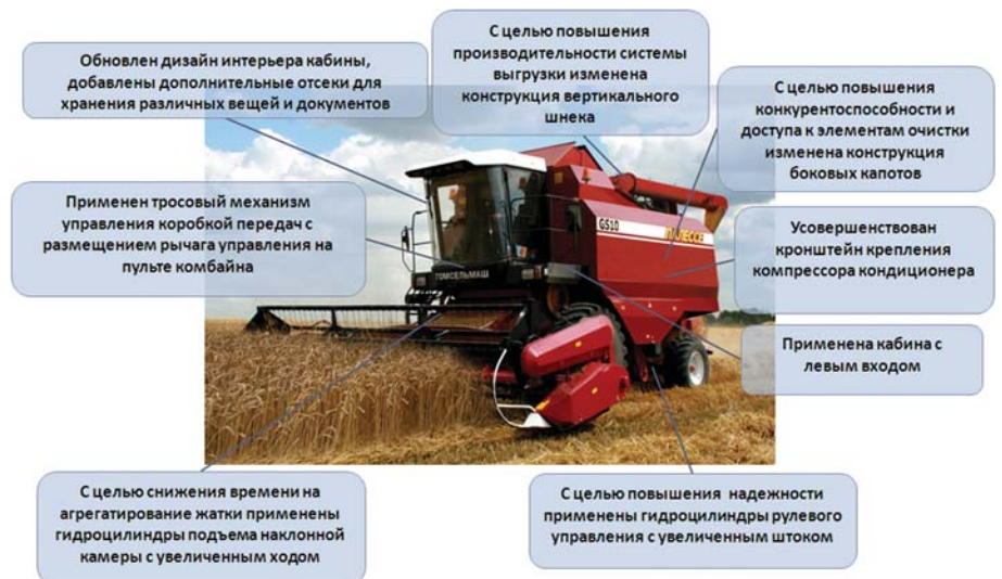
Рис. 3 – Конструкционные изменения, внесенные в комбайн зерноуборочный самоходный КЗС-10К "ПАЛЕССЕ GS10"
