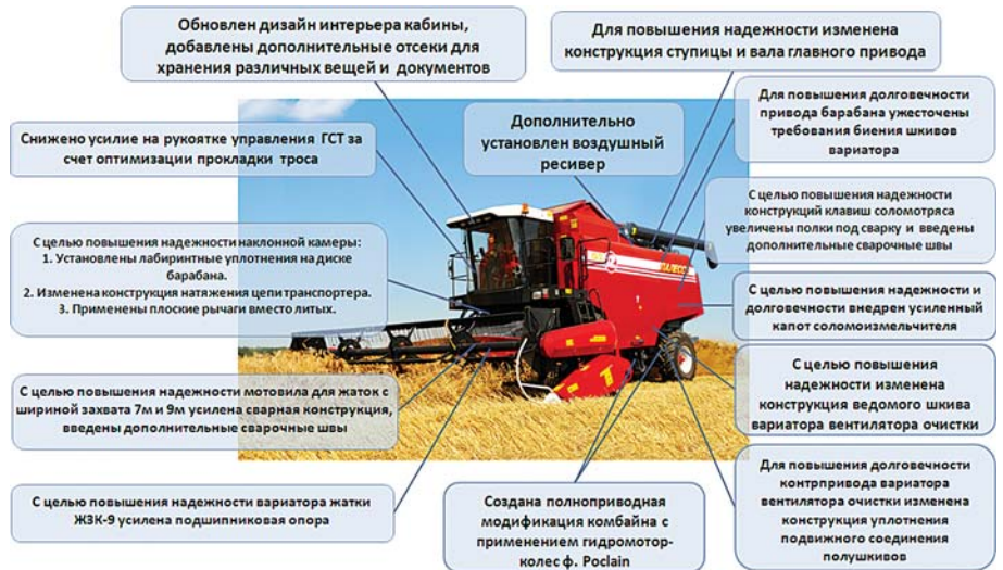
Рис. 2 – Конструкционные изменения, внесенные в комбайн самоходный зерноуборочный КЗС-1218 "ПАЛЕССЕ GS12"
