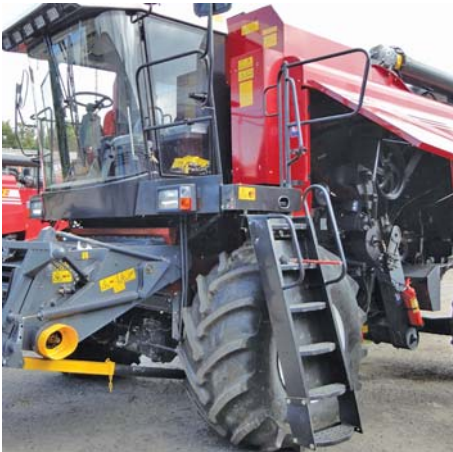
Рис. 7 – Доступ до передач за піднятого положення захисного щитка лівої боковини молотарки
