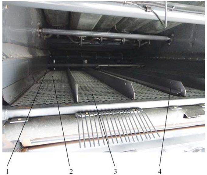
Рис. 3 – Система очищення зерна жалюзійного типу: 1 – решето-подовжувач, 2 – верхнє решето, 3 – решето-подовжувач та 4 – вертикальні «реборди» решітного стану
