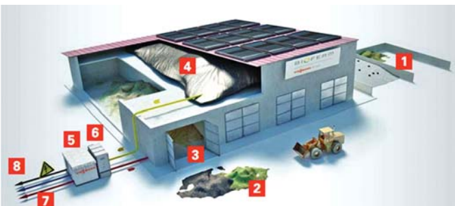
Рис. 5 – Схема технологічного процесу BIOFerm: 1 – майданчик для біомаси; 2 – майданчик змішування; 3 – реактор; 4 – газгольдер; 5 – тепла установка; 6 – теплоенергогенератор; 7 – трубопроводи теплопостачання; 8 – електроенергія
