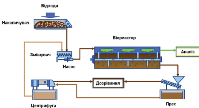
Рис. 10 – Схема технологічного процесу Komprogas
