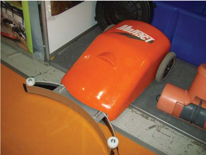
Рис. 1 – Пристрій для прибирання гною в тваринницьких приміщеннях
