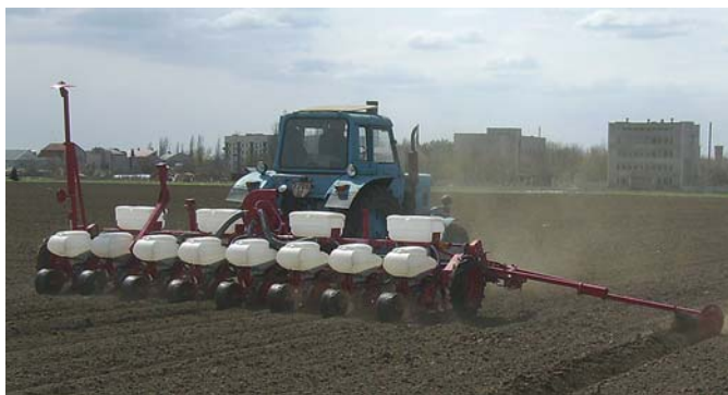
Рис. 1 – Сівалка УПС-8, обладнана системою контролю SCSO-8 в роботі
