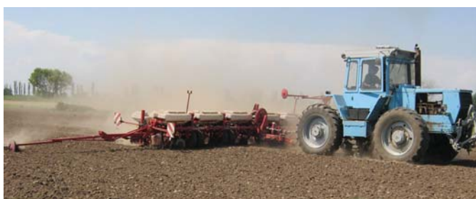
Рис. 2 – Сівалка Вега-12, обладнана системою контролю SCSO-12 в роботі
