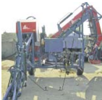
1 – збиральна секція; 2 – вивантажувальна секція Рис. 1 – Загальний вигляд морквозбирального комбайна (вигляд спереду) СМ-1000 Е
