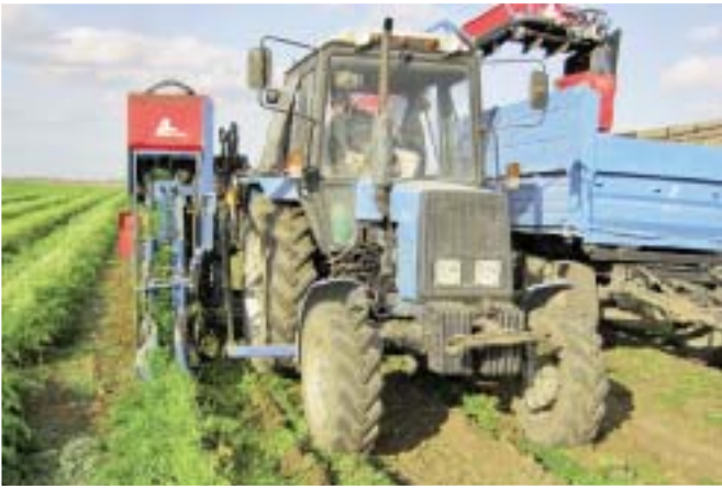
Рис. 8 – Морквозбиральний комбайн SM-1000 E у роботі (вигляд спереду)
