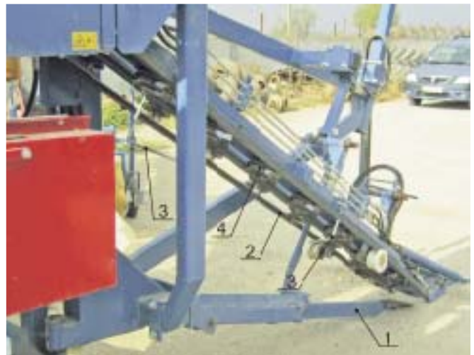
1 – підкопувальний леміш; 2 – пасовий транспортер; 3 – штанги видалення ґрунту; 4 – притискні ролики; Рис. 5 – Збиральна секція комбайна (вигляд збоку)
