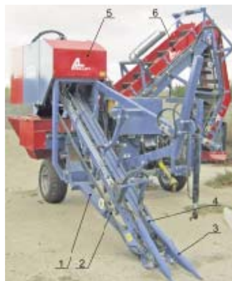
1 – підкопувальний леміш; 2 – пасовий транспортер; 3 – торпедний подільник; 4 – гідромотор привода торпеди; 5 – огороження механізму видалення бадилля; 6 – вивантажувальний транспортер
