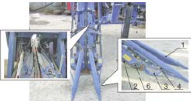
1 – торпедний подільник; 2 – пасовий транспортер; 3 – кронштейн механізму автоматичного контролю глибини підкопування; 4 – магнітний датчик; 5 – притискні ролики; 6 – нижній натяжний шків пасового транспортера Рис. 4 – Збиральна секція комбайна (вигляд спереду)
