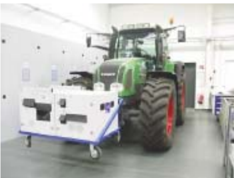
Рис. 3 – Комплект обладнання для оцінювання викидів двигунів під час виконання трактором основних технологічних операцій
