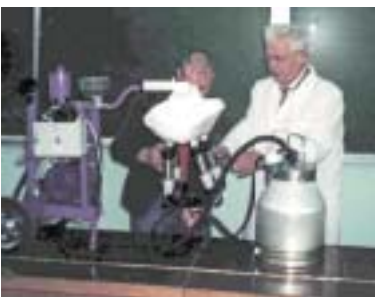
Рис. 1 – Лекційне дослідження фермерської доїльної машини: студент 3 курсу технологічного факультету ХДЗВА Самусь О. підключає доїльні стакани
