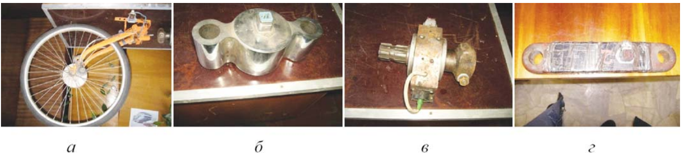
Рис. 2 – Універсальні тензозвули: а – “п’яте колесо” (для вимірювання швидкості та шляху), б – тензодинамометр (для визначення тягового опору); в – датчик крутного моменту; г – датчик для дослідження зусиль розтягування
