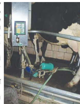
Рис. 5 – Автоматичний маніпулятор доїння
