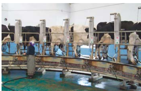
Рис. 3 – Доїльна установка-майданчик «Карусель»
