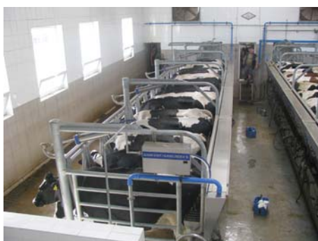
Рис. 4 – Доїльна установка-майданчик «Паралель»
