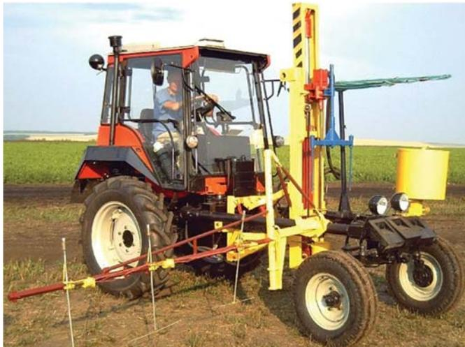
Рис. 1 – Мобильный диагностический агрегат МДА-СШ 30
