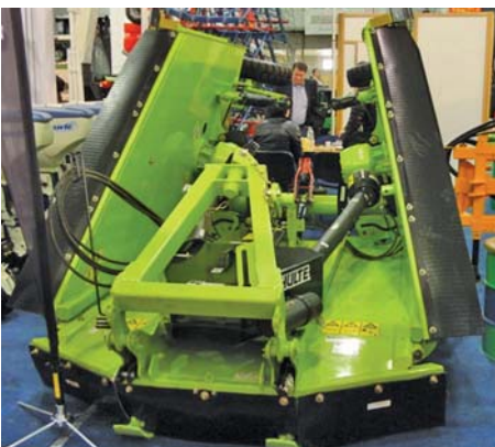
Рис. 13 – Подрібнювач-мульчувач FX-315 (загальний вигляд – у транспортному положенні)
