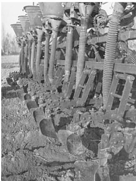
Агрегат для формування гребенів з одночасним внесенням добрив у зону рядка
