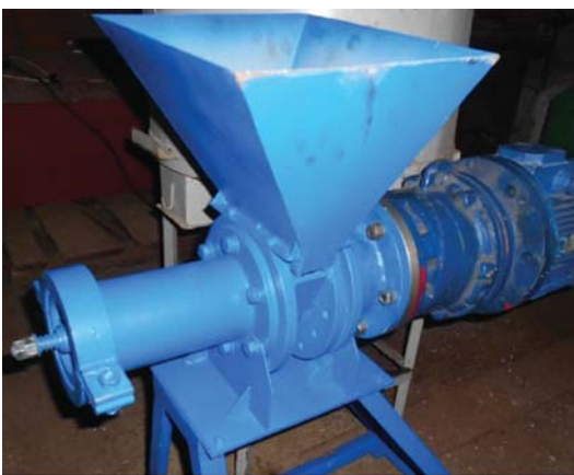
Рис. 1 – Гвинтові гранулятори кормів: а – конструкції ННЦ «ІМЕСГ», б – конструкції НВО «Селта» ННЦ «ІМЕСГ»
