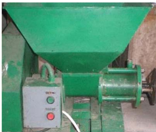
Рис. 1 – Гвинтові гранулятори кормів: а – конструкції ННЦ «ІМЕСГ», б – конструкції НВО «Селта» ННЦ «ІМЕСГ»
