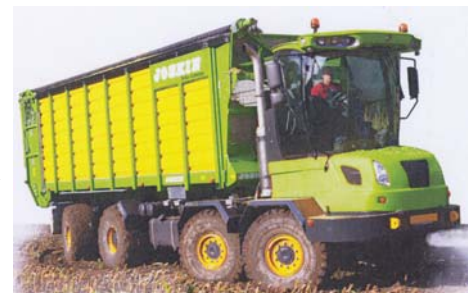
Рис. 14 – Самохідний причіп для перевезення зеленої маси Gargo-Tracк фірми «JOSKIN» (Бельгія)
