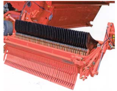
Рис. 9 – Відведення подрібнювального пристрою в сторону фірми «Pottinger» (Австрія) з ціллю здійснення обслуговування
