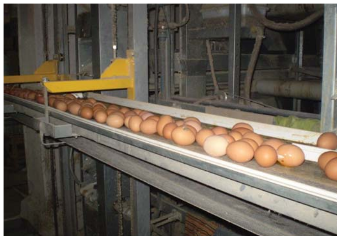
Рис. 3 – Поперечний транспортер збору яєць з ліфтовим механізмом обладнання ТБК
