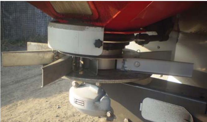
Рис. 2 – Розкидальний диск з приймальною камерою
