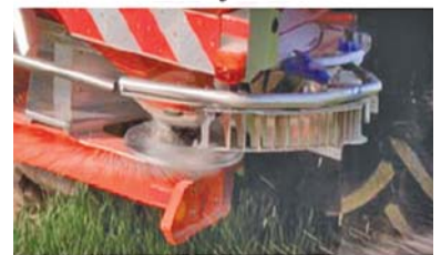
Рис. 5 – Системи, які встановлені на розкидачах для роботи на краю поля: а – Kverneland, б – Amazone, в – Rauch
