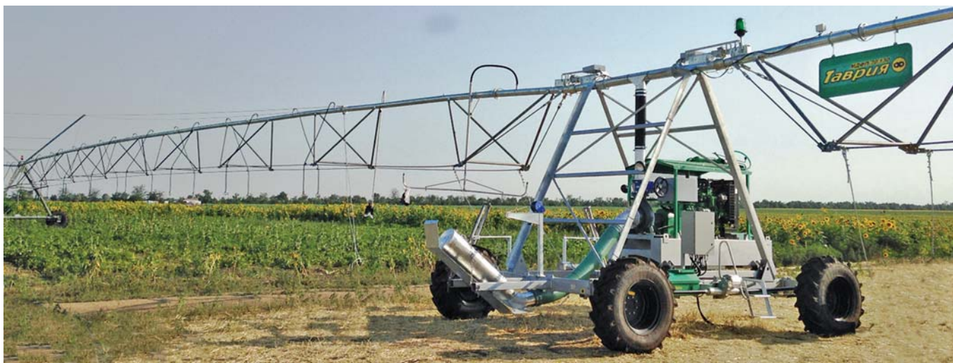
Рис. 1 – Дощувальна машина «Таврія» МДФП-70/130
