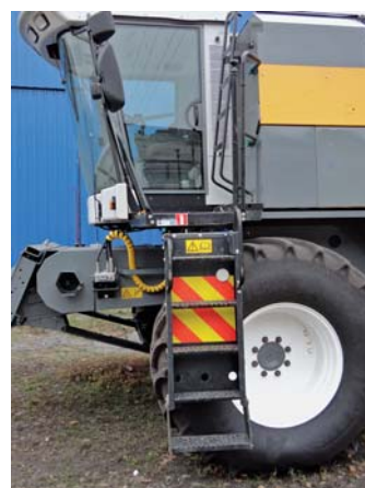
Рис. 7 – Ергономічна сучасна кабіна має зручний вхід і надійне огороження вхідної платформи
