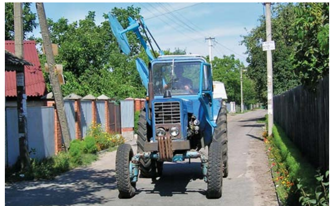
Рис. 4 – Транспортне положення безредукторної двороторної косарки
