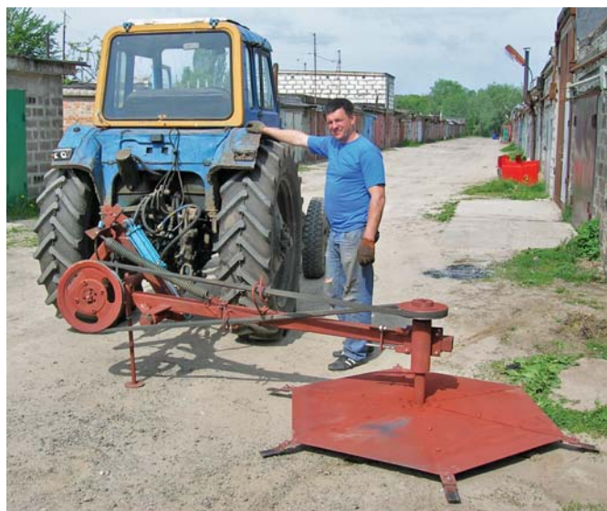
Рис. 1 – Однороторна безредукторна косарка 1,9 м захвату
