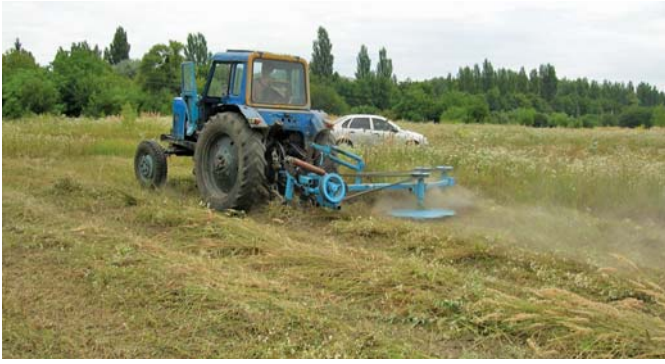
Рис. 2 – 2-роторна безредукторна клинопасова косарка шириною захвату 2,6 м в роботі
