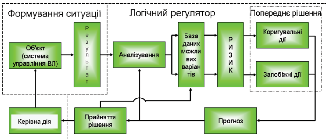
Рис. 3 – Розгорнута схема адаптивної системи прийняття рішення
