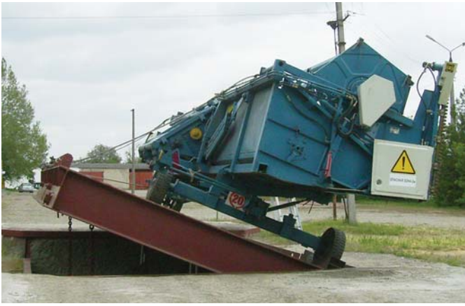
Рис. 6 – Визначення граничного кута поперечної статичної стійкості триколісного візка ВУ-3 з жнивваркою зерною ЖЗС-7 і змонтованим на ній пристроєм для збирання ріпаку ПЗР-6-01 на стенді СУ-40
