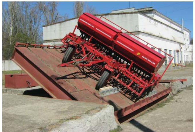
Рис. 5 – Визначення граничного кута поперечної статичної стійкості сівалки зернотукової пресової СЗП-3,6В-06 на стенді СУ-40
