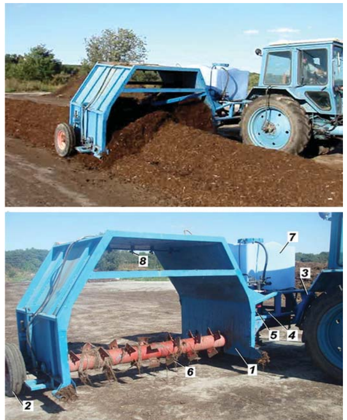
Рис. 1 – Загальний вигляд змішувача-аератора гноєкомпостних буртів: 1 – рама, 2 – опорні колеса, 3 – причіпний пристрій, 4 – карданний вал, 5 – редуктор, 6 – фрезерно-барабаний робочий орган, 7 – місткість для води, 8 – розпилювачі
