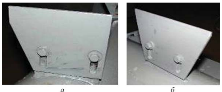
Рис. 2 – Похила (а) і пряма (б) лопаті робочого органу
