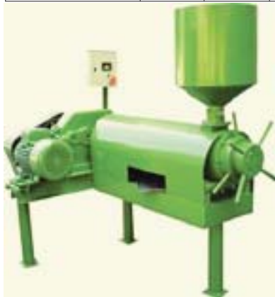
Рис. 3 – Олійний прес холодного пресування типу ПХП ПРАТ РНВП «Укреспо-Процес»
