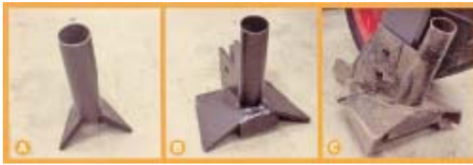
Рис. 3 – Типи змінних сошників в залежності від виду висівних рослин: А – посівний сошник: вузький ряд насіння посередині смуги ґрунту, що обробляється (наприклад, ріпак, соя, горох кукурудза); В – посівний сошник: вузькі ряди насіння по краях смуги ґрунту, що обробляється (наприклад, ячмінь, пшениця); С – посівний сошник: ряд насіння по всій ширині смуги ґрунту, що обробляється (наприклад, пшениця)
