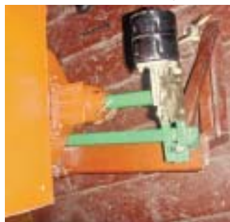
Рис. 4 – Електродвигун для приведення вала туковисівного апарата
