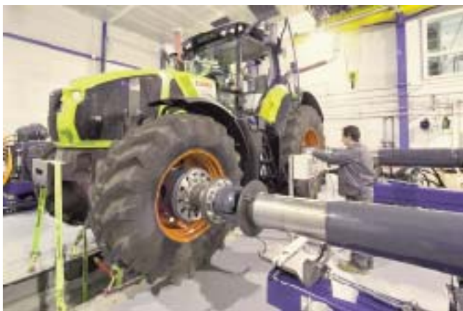
Рис. 1 – Випробування трактора AXION на гальмівному стенді
