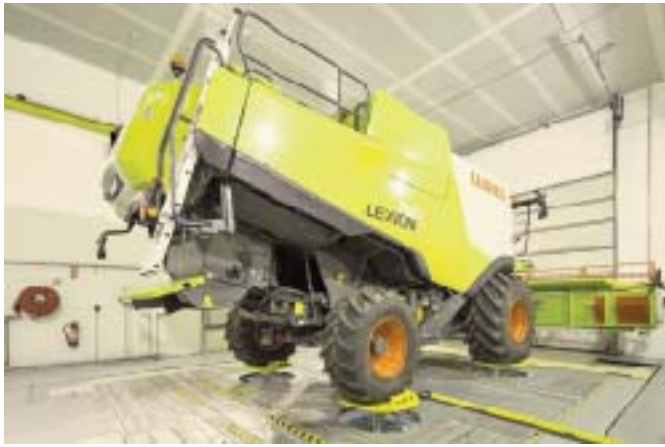
Рис. 3 – Випробування комбайна LEXION на вібраційному стенді
