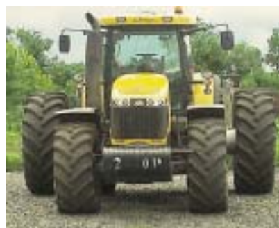
Рис. 4 – Конструкційне рішення для зменшення тиску на ґрунт
