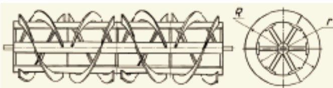
Рис. 1 – Креслення котка, у якого робочими елементами є відсіки гвинтових поверхонь
