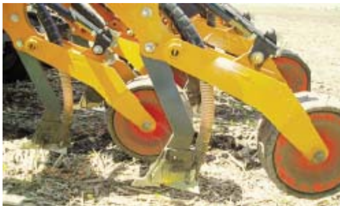
Рис. 3 – Робочі органи висівної частини
