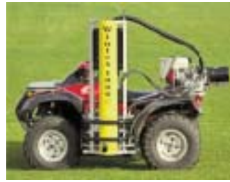
Рис. 16 – Пробовідбирач ґрунту Wintex 1000S від фірми Wintex-Агро
