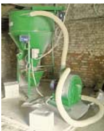
Рис. 4 – Малогабаритний комбикормовий агрегат ТОВ «Княжа Авіла»
