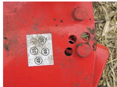
Рис. 6 – Отвори регулювання ширини захвату корпусу плуга «Мастер А4»
