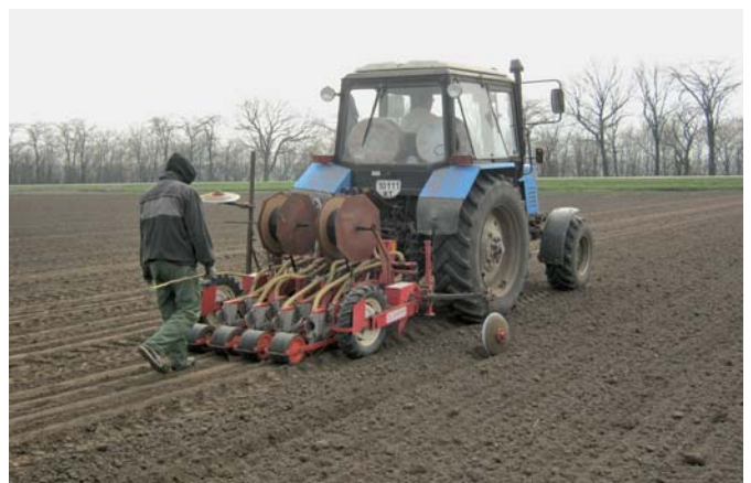
Рис. 4 – Сівалка овочева «Olimpia» в роботі
