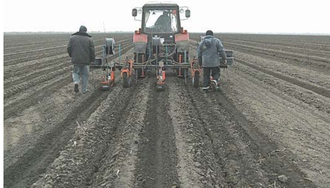
Рис. 3 – Сівалка овочева «Star 3R» в роботі
