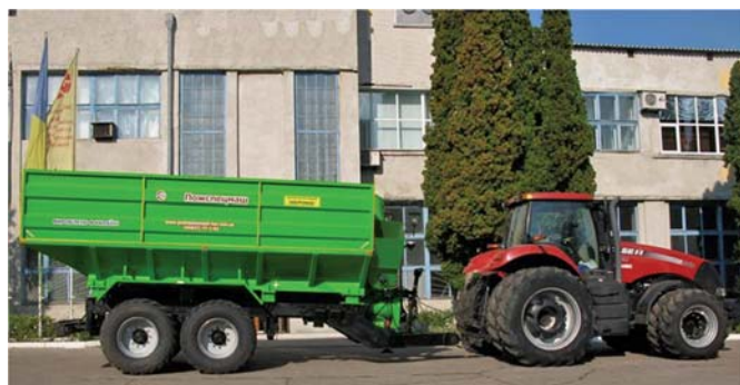
Рис. 1 – Перевантажувальний бункер-накопичувач зерна БНП-30
