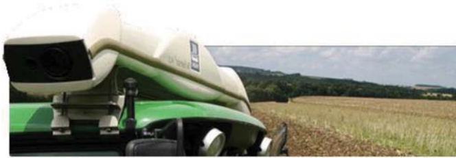
Рис. 11 – Активний сенсор азоту фірми Yara
