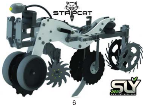
Рис. 2 – Сільськогосподарські знаряддя для реалізації технології STRIP-TILL: 1 - Pluribus (DAWN); 2 - 1tRiPr (Orthmen); 3 - Till-N-Plant (Schlagel); 4 - PST (Remlinger); 5 - 7600 (Sunflower); 6 - Stripcat (Slyfrance).
