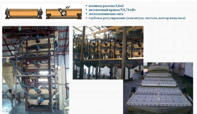
Рис. 10 – Очисно-калібрувальна машина високої продуктивності Фадєєва Л.В.
