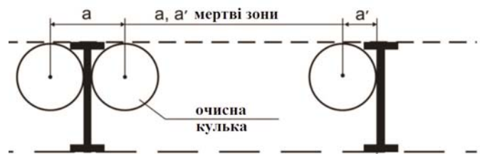
Рис. 8 – Мертві зони під час очищення сит пружними кульками
