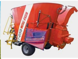
Рис. 31 – Міксери для ферм ВРХ фірми Metall Fach, місткість однороторних – 5-13 м 3 , двороторних – 14-18 м 3
