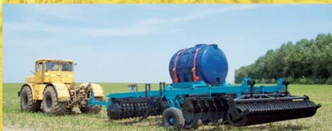
дискоцизельний агрегат БДВП-4,2-01 з комплектом обладнання для внесення рідких мінеральних добрив і біодеструктору стерні
