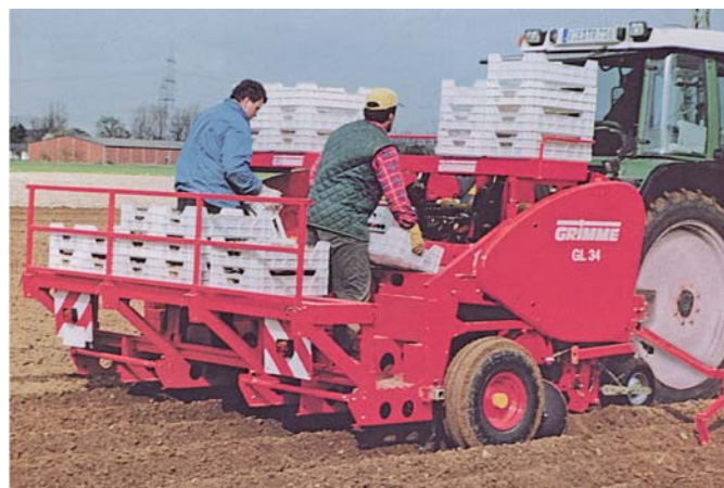
Рис. 17 – Картоплесаджальний комбайн GL34, оснащений додатковим пристроєм для посадки пророщеної картоплі
