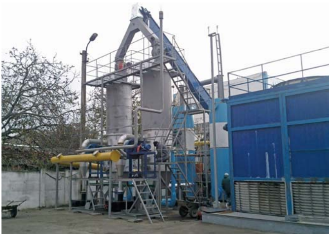
Рис. 26 – Газогенераторний комплекс продуктивністю 300 м 3 /год, установлений на маслозаводі м. Яготин в Київській області
