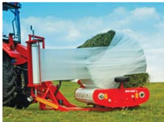
Рис. 30 – Обмотувальник рулонів поліетиленовою плівкою Z-552, діаметр рулонів – 1200х1200 мм, ширина плівки – 500 мм
