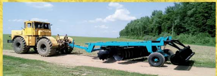
борона дискова важка причіпна БДВП-4,2-02 з робочими дисками діаметром 810 мм
