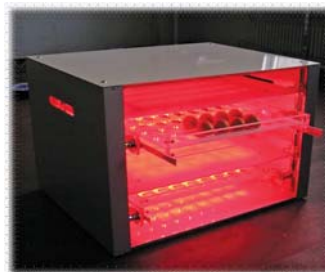
Рис. 3 – а – лазерна установка для активізації розвитку зародка яйця перед закладкою в шафу інкубатора; б – дослідний зразок лазерної установки для активізації розвитку зародка яйця перед закладкою в шафу інкубатора (для фермера). Розробники: д-р техн. наук, проф. Лисиченко Микола Леонідович, асист. Міленін Дмитро Миколайович
