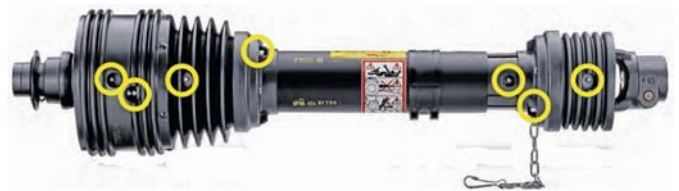
Рис. 2 – Система змащування карданних передач компанії «Bondioli & Pavesi»
