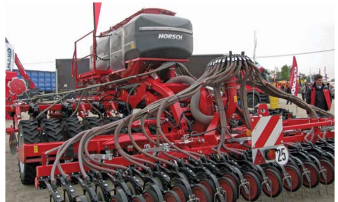
Рис. 8 – Ґрунтообробно-посівний агрегат фірми HORSCH
