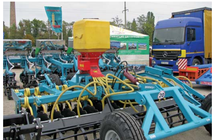
Рис. 3 – Дископак Д-4 з модулем сівби сидератів Turbo Jet
