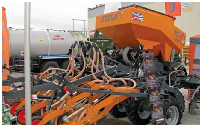
Рис. 4 – Агрегат для смугового обробітку ґрунту і посіву фірми MZURI (Великобританія)
