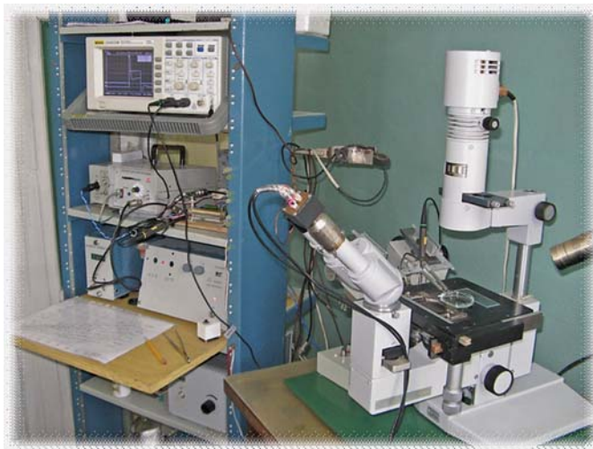
Рис. 4 – Апаратно-методичний комплекс імпульсної кондуктометрії для електроманіпуляції з біологічними клітинами та оцінки якості рідини. Розробники: д-р техн. наук, проф. Мегель Ю.Є., д-р техн. наук, с. н. с. Шигимага В.О.
