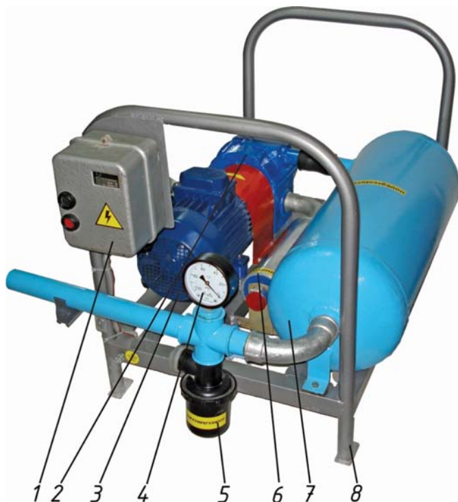
Рис. 2 – Загальний вигляд експериментальної вакуумної установки: 1 – пульт керування; 2 – вакуум-насос; 3 – електродвигун; 4 – вакуумметр; 5 – вакуум-регулятор; 6 – глушник; 7 – вакуум-балон; 8 – рама
