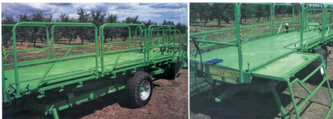
Рис. 16 – Садова платформа: а – транспортне положення; б – робоче положення
