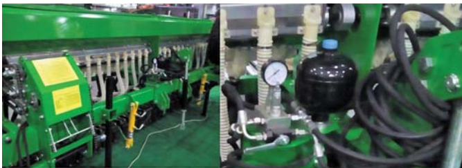
Рис. 6 – Загальний вигляд модернізованої сівалки СЗМ-4 «Ніка» (а), обладнаної гідроакумулятором (б) для покращення її технологічних можливостей
