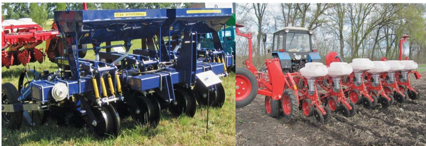
Рис. 4 – а – 4-х рядний агрегат СТА-4 для нарізання смуг та внесення добрив. б – Сівалка ВЕГА з блоком очисних зірочок
