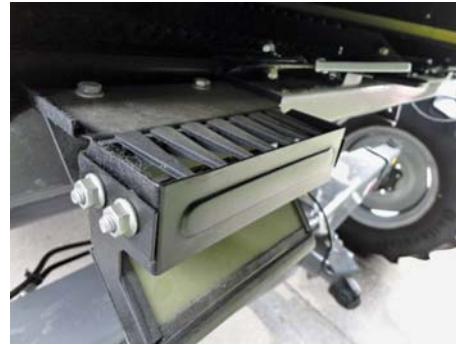
Рис. 4 – Електронні датчики для контролю втрат за системою очищення зерна
