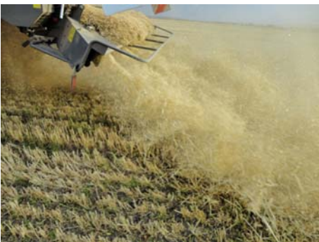
Рис. 9 – Робота системи подрібнення і розсівання соломи
