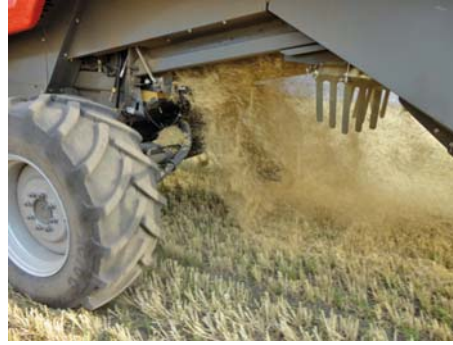
Рис. 10 – Виділення полови верхнім решетом системи очищення зерна
