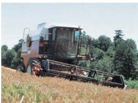
Рис. 6 – Гідромеханічна система AVTO LEVEL дозволяє вирівняти молотарку і весь комбайн до горизонтального положення (під час роботи на схилах)
