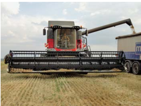
Рис. 13 – Високе положення зернового шнека дозволяє без проблем вивантажувати зерно в сучасний зерновоз
