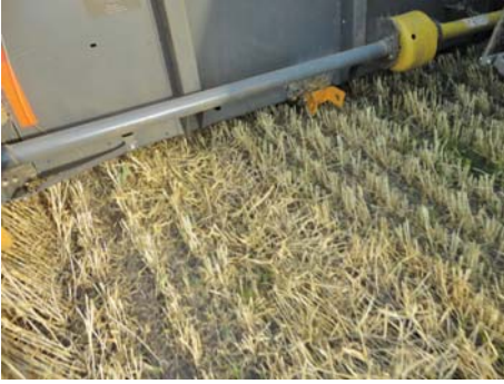
Рис. 8 – Так працює жатка: чистий зріз стебел, низька стерня, відсутність втрат, у зоні боковини (зліва від жатки) хлібний масив не приминається до землі
